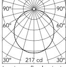
Luminous flux luminaire 607 lm
