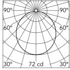
Luminous flux luminaire 202 lm
