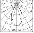
Luminous flux luminaire 652 lm
