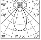
Luminous flux luminaire 683 lm
