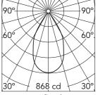
Luminous flux luminaire 652 lm
