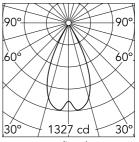
Luminous flux luminaire 769 lm
