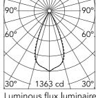
Beam Angle: 45° h(m) = E(Ix)D(m) 1363 0.83 2 1.67 341 3 151 2.50 3.34 85 5 55 4.17
