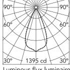
Beam Angle: 46°  $E(I_X)$ D(m) h(m) 1395 0.84 349 1.69 3 155 2.53 4 87 3.38 56 4.22
