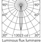
Beam Angle: 10° h(m) E(lx) D(m) 13023 0.18 3256 0.36 3 1447 0.55 4 814 0.73 521 0.91
