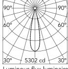
Beam Angle: 22° h(m) = E(Ix)D(m) 5302 0.39 2 1325 0.78 3 589 1.17 4 1.56 332 5 212 1.95
