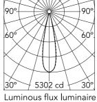
Beam Angle: 22° h(m) = E(Ix)D(m) 5302 0.39 2 1325 0.78 3 589 1.17 4 1.56 331 5 212 1.95
