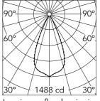
Beam Angle: 46° h(m) E(lx) D(m) 1488 0.84 2 372 1.69 3 165 2.53 4 93 3.38 5 60 4.22
