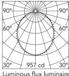
Luminous flux luminaire 2524 lm
