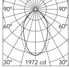
Luminous flux luminaire 3044 lm
