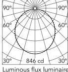
Beam Angle: 107° h(m)  $E(I_X)$ D(m) 846 2.63 2 5.26 211 3 94 7.90 4 53 10.53 5 34 13.16
