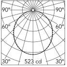
Luminous flux luminaire 1424 lm
