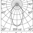
Luminous flux luminaire 553 lm
