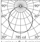
Luminous flux luminaire 2135 lm
