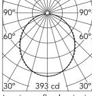
Luminous flux luminaire 1068 lm
