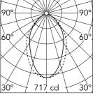
Luminous flux luminaire 1107 lm
