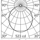
Luminous flux luminaire 1424 lm
