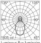
Luminous flux luminaire 4327 lm
