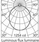
Beam Angle: 103° h(m) E(Ix)D(m) 1254 2.54 2 313 5.07 3 139 7.61 4 78 10.14 5 50 12.68
