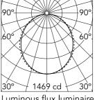
Beam Angle: 103° h(m) E(Ix)D(m) 2.54 1469 2 367 5.07 3 163 7.61 92 10.14 5 59 12.68
