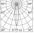
Luminous flux luminaire 1096 lm
