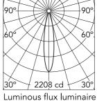
Beam Angle: 19°  $E(I_X)$ D(m) h(m) 2208 0.34 552 0.67 3 245 1.01 4 138 1.34 88 1.68
