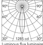
Beam Angle:  $E(I_X)$ D(m) h(m) 1285 0.35 321 0.70 3 143 1.06 4 80 1.41 51 1.76
