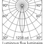
Luminous flux luminaire 186 lm
