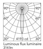
Beam Angle: 14° h(m) = E(Ix)D(m) 4193 0.24 1048 0.49 3 466 0.73 4 262 0.97 168 1.21
