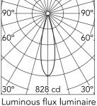
Beam Angle: 25° E(Ix)D(m) h(m) 1 828 0.45 2 207 0.89 3 92 1.34 4 1.79 52 33 2.23
