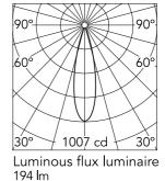
Beam Angle: 25°  $E(I_X)$ D(m) h(m) 1007 0.45 252 0.89 3 112 1.34 4 1.79 63 40 2.23
