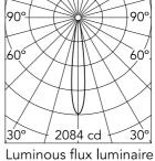
Beam Angle: 15°  $E(I_X)$ D(m) h(m) 2084 0.26 521 0.52 3 232 0.77 4 130 1.03 83 1.29
