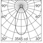
Luminous flux luminaire 3300 lm
