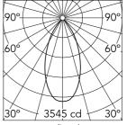
Luminous flux luminaire 3300 lm
