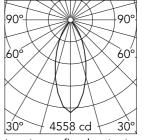
Luminous flux luminaire 3400 lm
