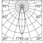
Luminous flux luminaire 3400 lm
