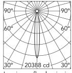
Luminous flux luminaire 3400 lm
