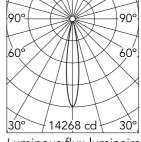
Luminous flux luminaire 1475 lm
