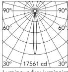
Luminous flux luminaire 544 lm
