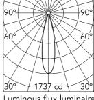
Luminous flux luminaire 362 lm
