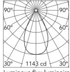
Luminous flux luminaire 1135 lm
