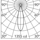
Luminous flux luminaire 261 lm
