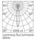
Beam Angle: 14° h(m) = E(Ix)D(m) 2558 0.25 640 0.51 3 284 0.76 4 160 1.02 102 1.27
