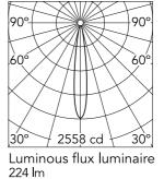
14° Beam Angle: h(m) E(lx)D(m) 2558 0.25 1 640 0.51 3 284 0.76 4 160 1.02 5 102 1.27
