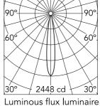
14° Beam Angle: h(m) = E(Ix)D(m) 2448 0.25 2 0.51 612 3 272 0.76 4 153 1.02 5 98 1.27
