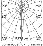
Beam Angle: h(m) = E(Ix)D(m) 5878 0.24 1469 0.49 3 653 0.73 4 367 0.97 235 1.21
